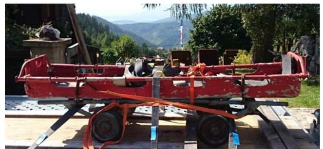
Das gefederte Untergestell hat kunststoffummantelte Laufflächen und wird händisch gefördert. Der Aufbau besteht aus einem Aluminium-Grubenschleifkorb, der mit vier Hackenfedern auf das Gestell geschnallt ist. ■
