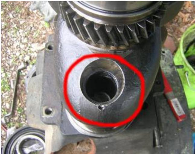
Beispiel Steyr-Kurbelwelle: Hier sehen wir die gereinigte Bohrung, der Ölfluss ist wieder möglich
