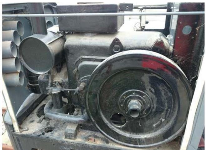
Lok JW15 1430/1966 mit Motor aus 1101/1952; im Zuge der Motoridentifikation wurden gleich Konservierungsarbeiten durchgeführt, um eine eventuelle Wiederinbetriebnahme zu erleichtern
