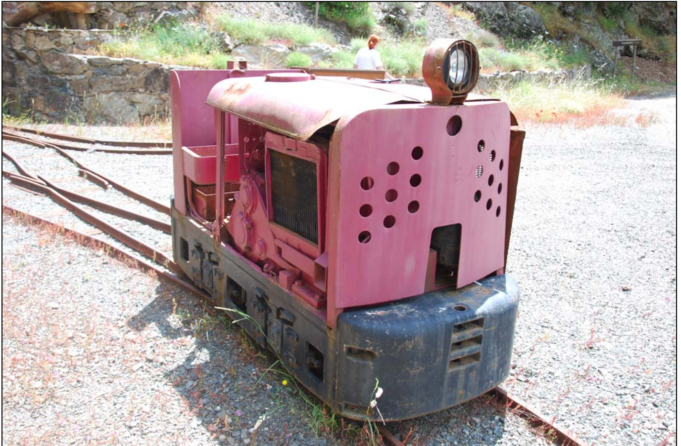
Jenbacher JW20 2552/1969, elektrische Komponenten entfernt, aber in relativ gutem Zustand.
