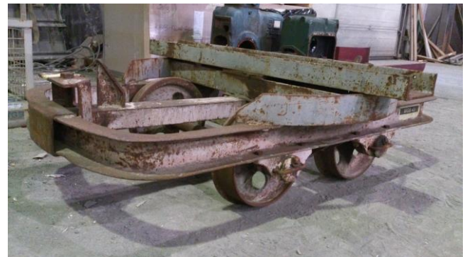
Einer von zwei Drehchemelwagen im Februar kurz vor dem Sandstrahlen
