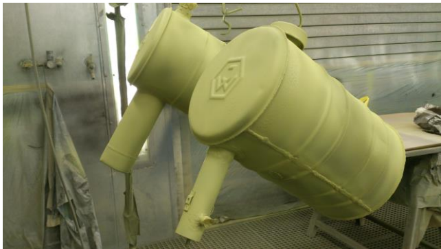
Jenbacher Tank der 1. Generation (Bj. 1949) mit integriertem Dieselfilter (Vordergrund)
