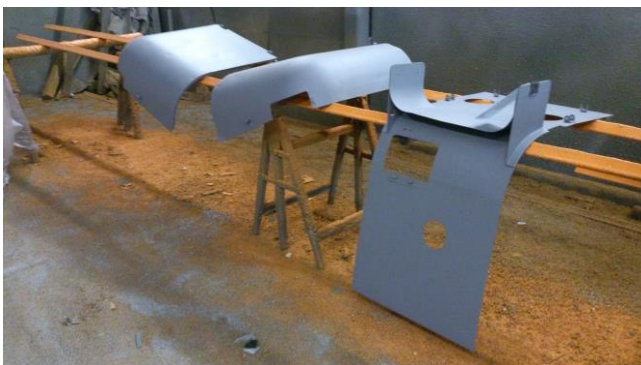
Jenbacher-Büffel-Teile gestrahlt und grundiert; lackiert werden sie in „JW-blau“ RAL 5012
