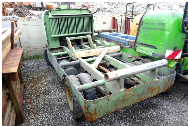
#1 JW 5.510.511, schön zu sehen der Druckluftkühler an der Rückseite sowie der Druckluftbehälter vor den linken Hinterrädern
